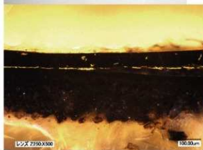
No.305 スペクトル・塗膜断面
