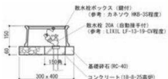
Fig.172 散水栓詳細図
