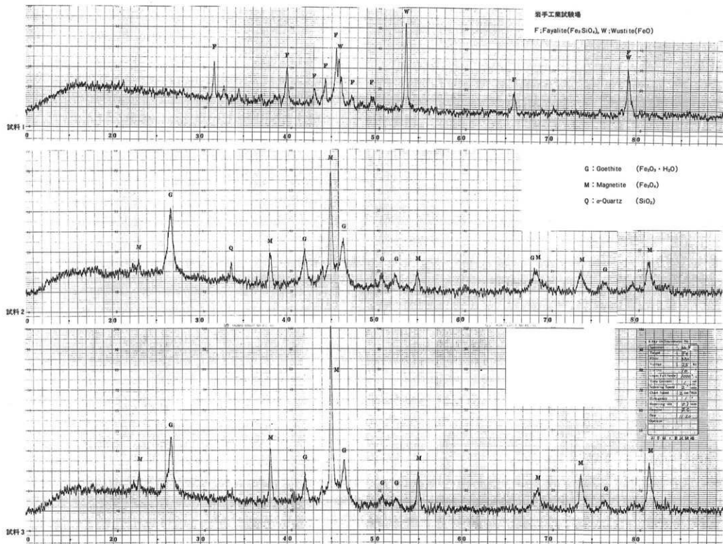
第3図 鉄滓・鉄製品のX線回折グラフ
