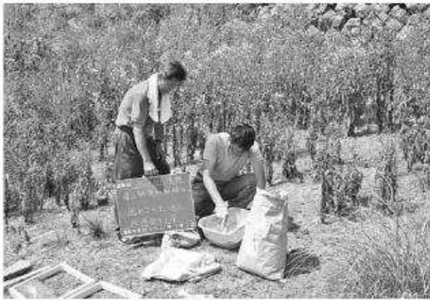
写真216 平成21年9月7日実施墳丘舗装材試験片作成
