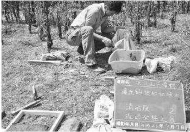
写真218 平成21年9月7日実施墳丘舗装材試験片作成
