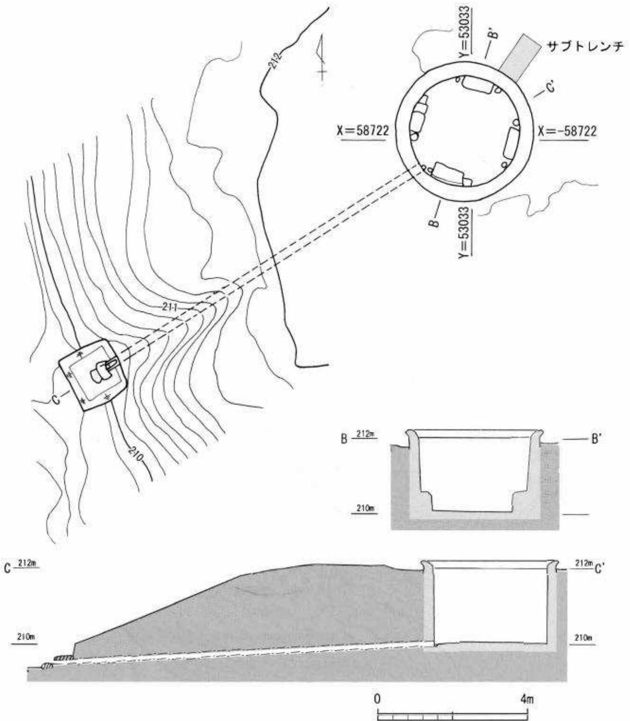
第6図 北浜防空監視哨跡跡音壕平面図(上)・断面図(中・下)(1:100)
