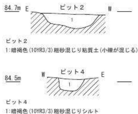
図27 ビット2・4断面図(S=1/40)
