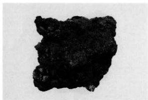
60-115 炉内滓 (溶解炉・含鉄)
