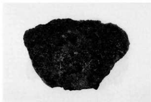
58-106 炉壁 (溶解炉・鉄粒付き・含鉄)
