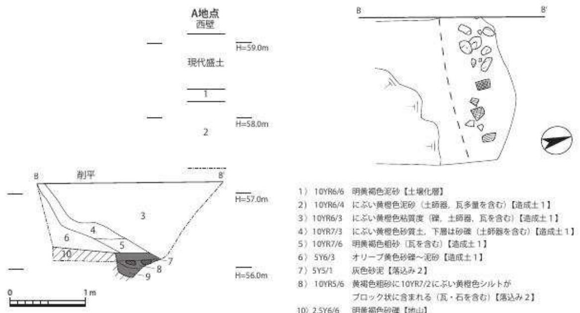
図56 調査区平面断面図 (1 : 50)
