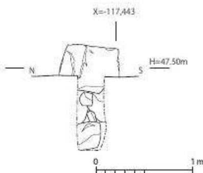
図10 石垣前面断面図 (1 : 40)
