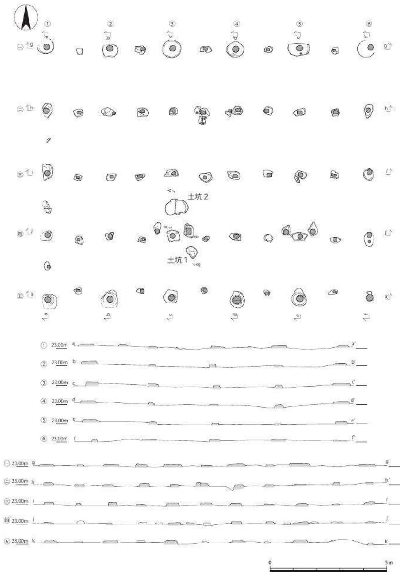
图 35 床下礎石平面图 (1 : 100)
