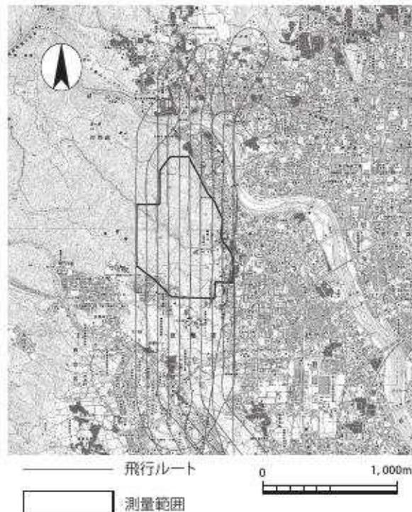
図84 計測飛行ルートと測量範囲(1:40,000)
