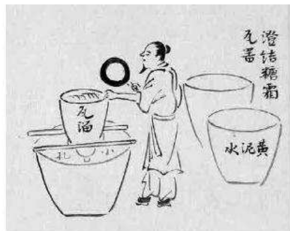
図56 糖漏使用法（天工開物より）
