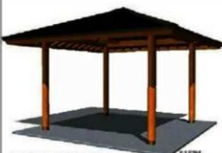
通常時、景観になじむ涼亭として、災害時には、桁に架けたパイプにテントをかけ、緊急の避難室等として利用できます。
