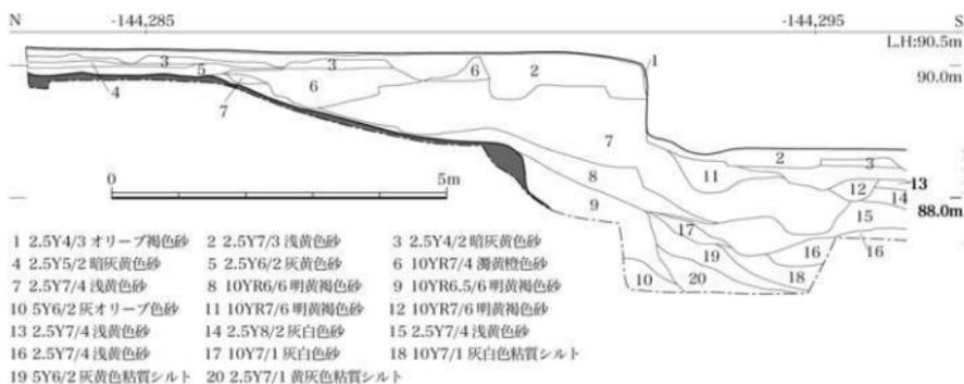
図25 試掘2010-4次調査 西区東壁土層図 (1/80)
