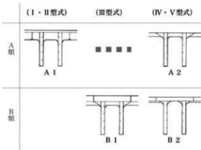
図283 底部製作方法の分類（模式図）
