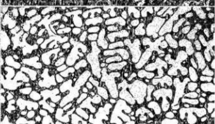
Photo.13 再結合滓の顕微鏡組織
