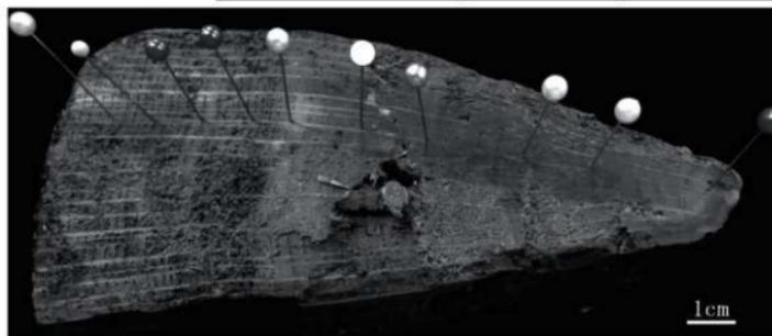
写真2 試料No.10 (SK211R-3) の年輪計測結果
