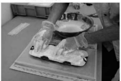
写真 05 石膏によるバックアップ（工程②）
