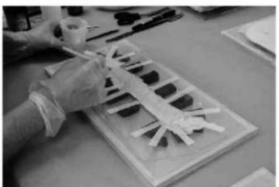
写真 03 型の分割面を設定しシリコーンゴムを塗布（工程②）
