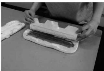
写真 12 硬化後成形品を取り出す（工程③）
