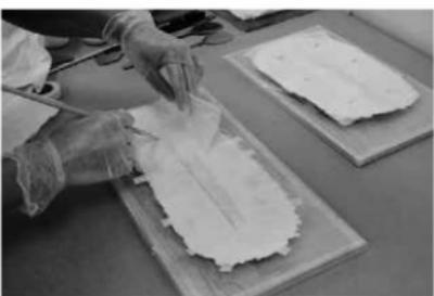
写真 04 ガーゼによるシリコーンの補強（工程②）
