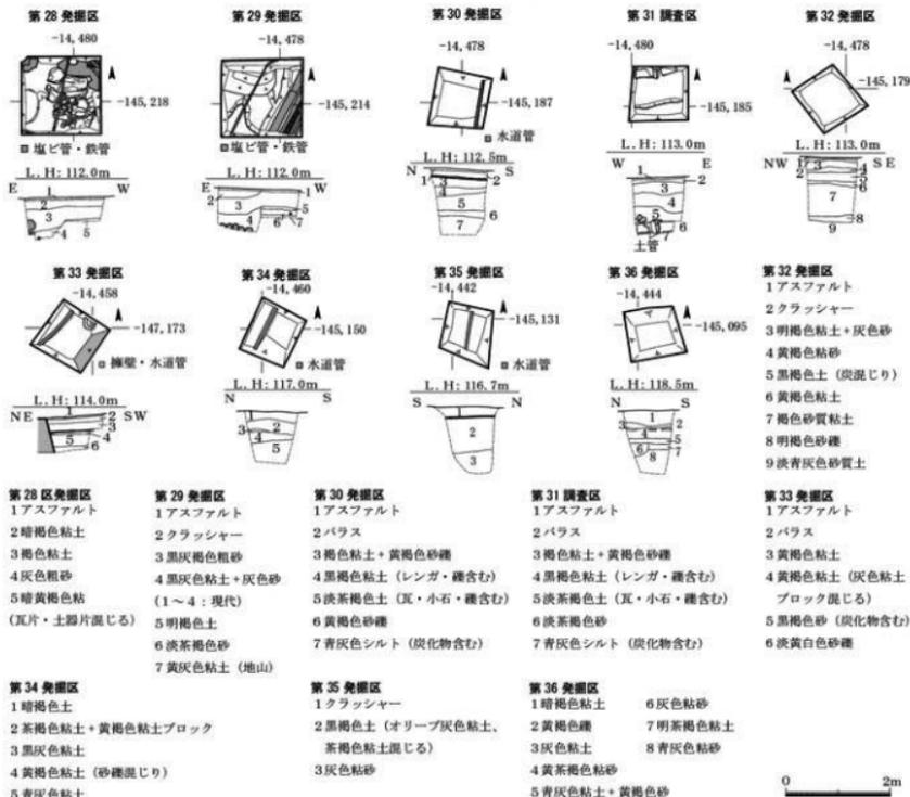
第28～36発掘区遺構平面図・土層図 (1/100)
