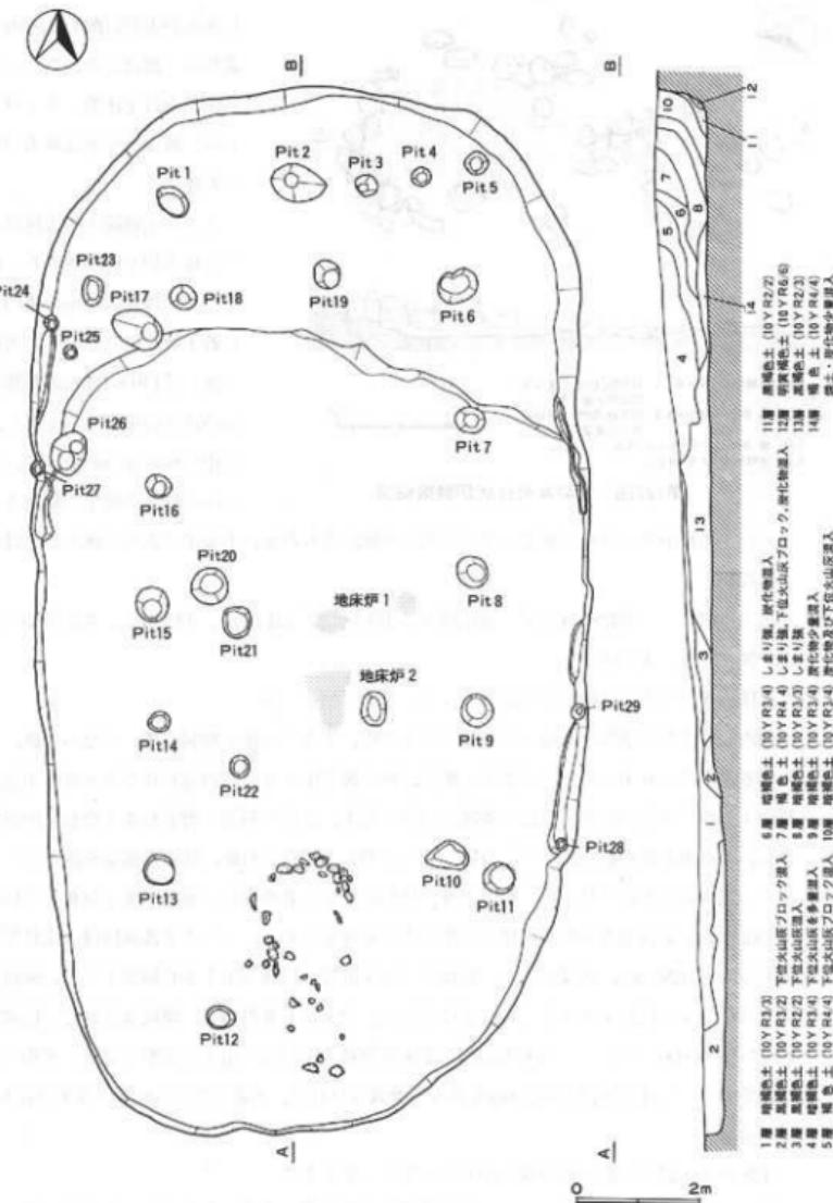
第126図 第42A号竪穴住居跡実測図
