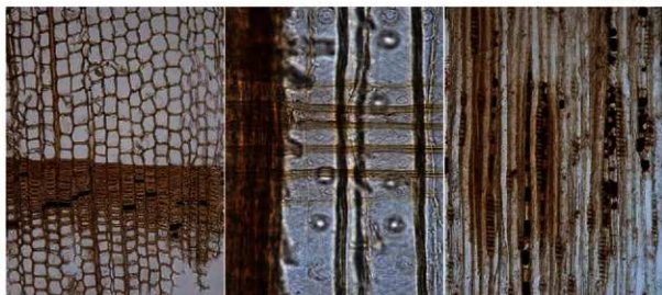
横断面 0.1mm 放射断面 0.1mm 接線断面 0.1mm 1. スギ 報868 箱物(部材) SD21
