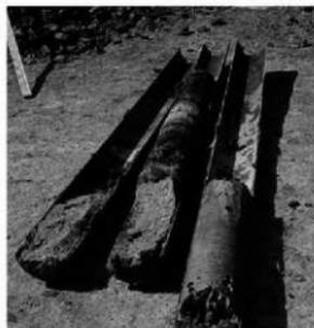
溶接を取り外した鋼管中の土塊
