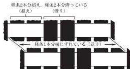
第20図 超え・潜り・送りによる網代編み分類・表現方法 [松永 2006] から転載
