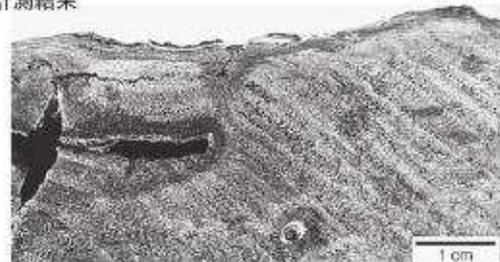
第 10 図 丸太材断面 d 表面の圧密
