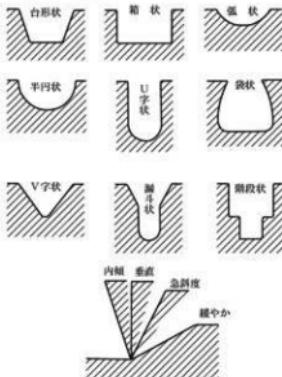
第8図 遺構の平面・断面形態の分類〔荒川・加藤 1999〕
