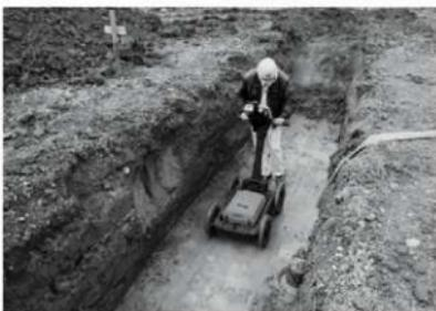
図37 地中レーダー探査状況
