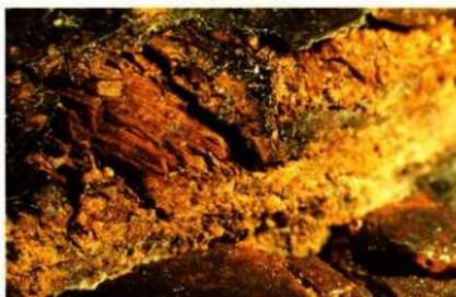
写真38 鉄槍 (164) A・C材接合状況 (6倍)
