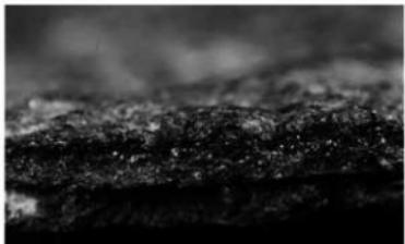
fig.333 S-2破断部分実体鏡写真（24倍）
