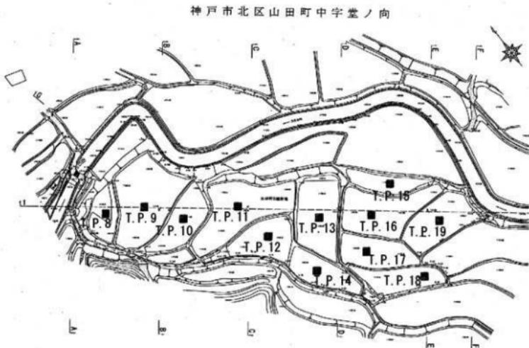
fig.206 試掘坑配置図
