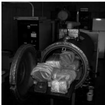
右下) fig.341 真空凍結乾燥作業
