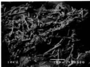
SEM像 口径1μm、長さ10μm前後のパイプ状粒子が観察される。
