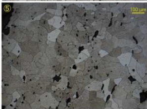
Photo. 12 梘形鍛冶滓(含鉄・鍛造品付)の顕微鏡組織
