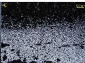
Photo. 14 鉄製品(鍛造品)の顕微鏡組織
