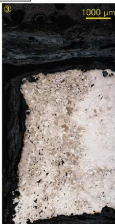
Photo. 12 梘形鍛冶滓(含鉄・鍛造品付)の顕微鏡組織
