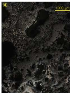
Photo. 5 梘形鍛冶滓・流出孔滓の顕微鏡組織
