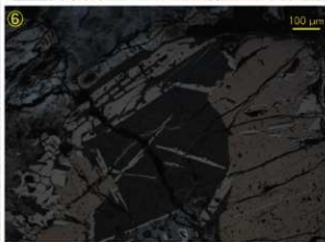
Photo. 2 炉外流出滓・鉄塊系遺物の顕微鏡組織
