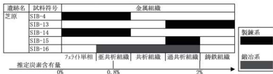
Fig. 2 芝原遺跡出土鉄塊系遺物・含鉄鉄滓の断面金属組織調査結果
