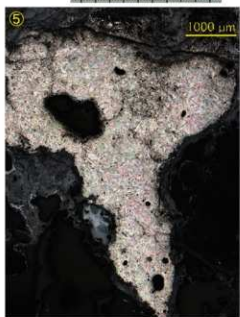
Photo. 9 鍛造剥片・鉄塊系遺物の顕微鏡組織
