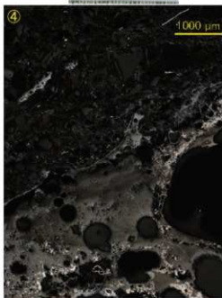
Photo. 4 椀形鍛冶滓の顕微鏡組織
