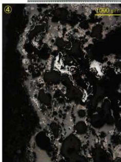
Photo. 3 羽口・椀形鍛冶滓の顕微鏡組織
