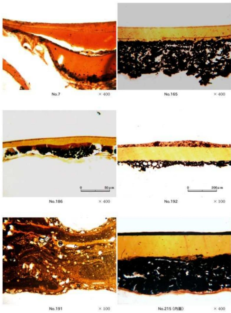
第13図 漆器塗膜層断面の顕微鏡写真（1）
