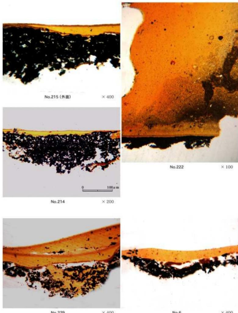
第14図 漆器塗膜層断面の顕微鏡写真（2）
