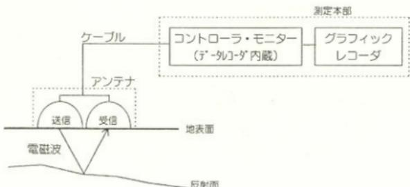
図-1 地下レーダー装置ブロックダイヤグラム
