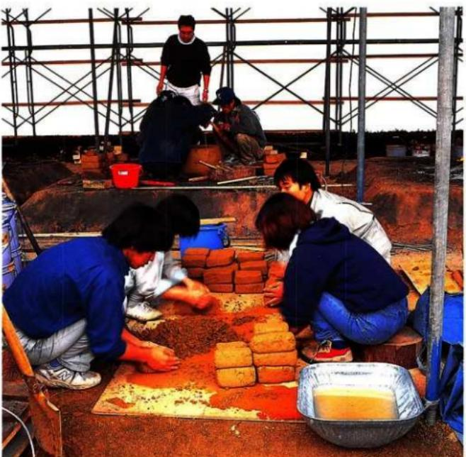
窯炉／染炉用の粘土ブロック作り。
