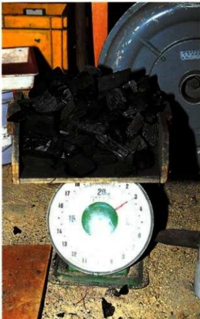
操業／炉内に装入する木炭は、そのたび毎に重量を測り使用する。
