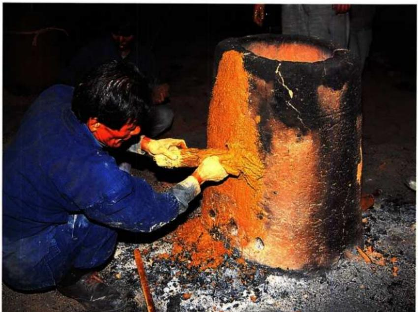
窯炉／強制乾燥後、ヒビが入った炉を補修する。
