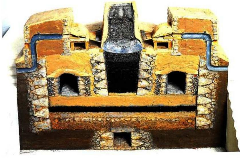
日刀保たら炉床断面模型
