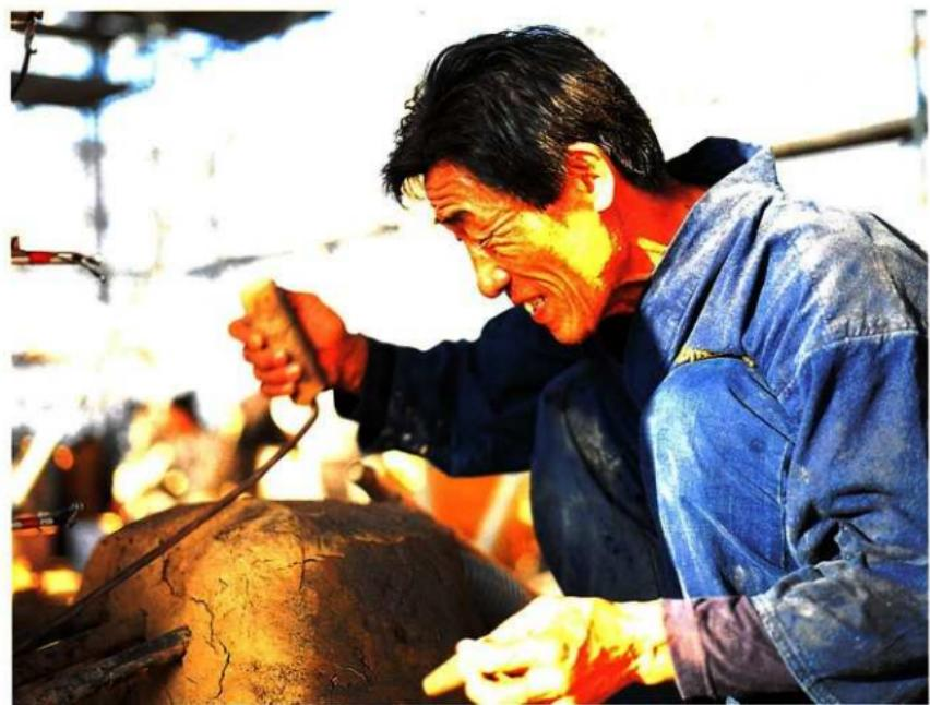
操業／2号炉炉内のホト穴周辺についたノロを「ホド突き」を用い取り除く。
