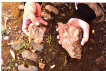
写真① 轰泉水道に使用されていた「がんぜき」(左側)と「石材」(右側)
