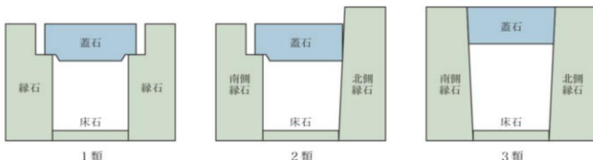
第7図 蓋付溝の構造模式図
