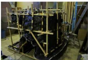
ポリエステル樹脂及びガラス繊維を積層（FRP成形）
