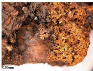
図 19. 観察箇所3-bの顕微鏡画像(布の痕跡)
