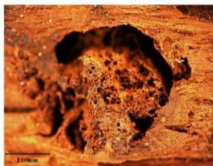
図188. 観察箇所96-bの顕微鏡画像(孔内の木質)
