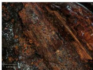
図 23. 観察箇所11-aの顕微鏡画像(付着木質)
