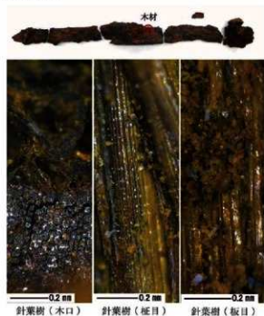
図10. 鉄剣 (No.3)の全景と付着木材の組織
