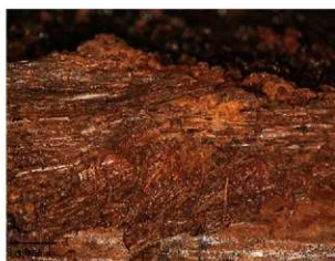
図109. 観察箇所50-cの顕微鏡画像(毛様付着物)
