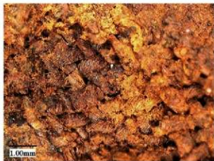
図 55. 観察箇所10-aの顕微鏡画像(平織布)
