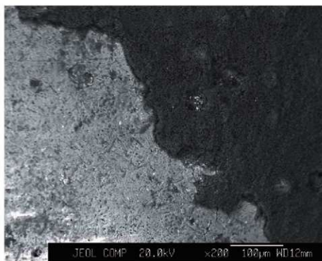
図 5-1 資料 5 (90 号-⑤, No. 211) の反射電子像 (左側の白色部分の上を右側の灰色部分が覆っている)
