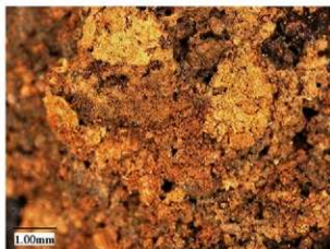
図 47. 観察箇所9-aの顕微鏡画像(布の痕跡)
