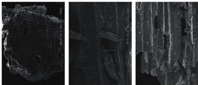
図 24. No. 4 鉄剣 採取木片のSEM画像(木口面, 柾目面, 板目面)
