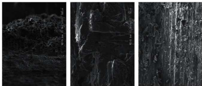
図 31. No. 6 鉄剣 採取木片のSEM画像(木口面, 柱目面, 板目面)
