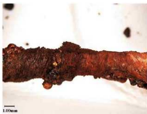
図205. 観察箇所100-aの顕微鏡画像(糸巻)
