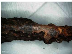
図 57. 観察箇所19-aの顕微鏡画像(葉脈状の痕跡)
