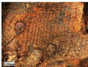
図 99. 観察箇所23-cの顕微鏡画像(平織布)
