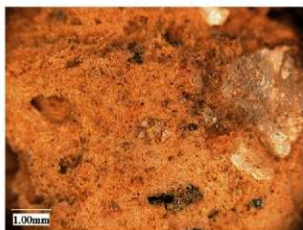
図 122. 観察箇所26-eの顕微鏡画像(皮革)
