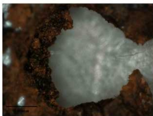
図 12. 観察箇所6-cの顕微鏡画像(孔内の有機質)
