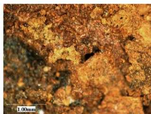
図 106. 観察箇所24-bの顕微鏡画像(布の痕跡)
