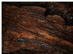
図 19. 観察箇所10-cの顕微鏡画像(付着木質)
