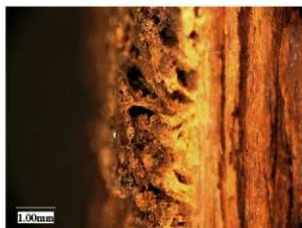
図 158. 観察箇所31-eの顕微鏡画像(組紐断面)
