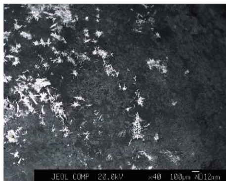
図9-1 資料9（126号-④、No.346）の反射電子像（灰色地の上に繊維状の白色物が析出している）
