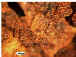
図 38. 観察箇所7-fの顕微鏡画像(葉脈状の痕跡)
