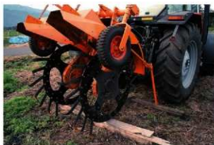
ゴボウトレンチャー(掘削部分)
