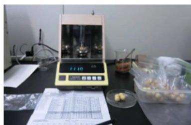
写真2 圧壊硬度測定試験
