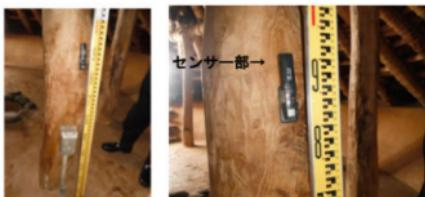
写真5 温湿度データロガー設置状態
