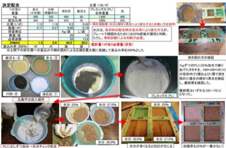
図4 決定された最適配合比と施工方法の検証試験
