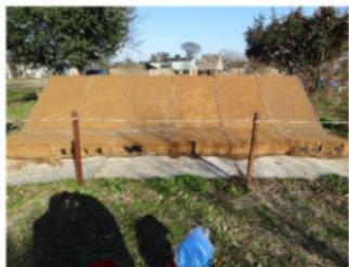
写真7 崩落土堆積状態
