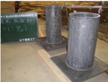
写真 248 柱脚金具 ケレン掛け後
