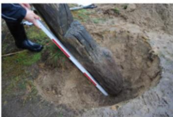
写真 235 土中埋設部分(砂質土のため樹皮も遺存)
