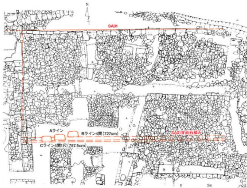
第28図 B-11・12、C-12 石積みSA01 背面石積みの根石設置状況模式図
