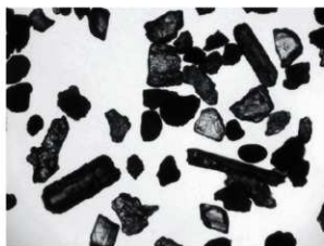
写真2 基本土層B・Ⅳ層の顕微鏡写真(透過光) 長柱状有色鉱物:斜方輝石。
