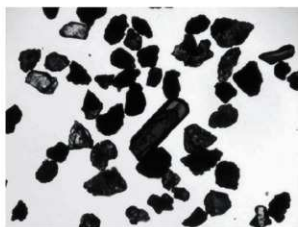
写真3 基本土層B・Ⅴ層の顕微鏡写真(透過光) 中央(長板状有色鉱物):角閃石。
