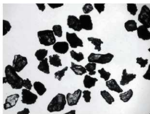
写真5 5号住居址・試料Bの顕微鏡写真(透過光) 中央ほか:スポンジ状軽石型ガラス, 中央左下・右下:繊維束状軽石型ガラス, 左上(有色鉱物):斜方輝石。
