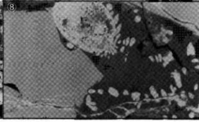
Photo. 1 流動滓と含鉄鉄滓の顕微鏡組織
