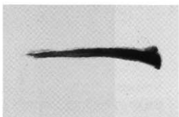
写真10 資料No. 4 II区SK49鉄釘 X線写真角形釘であった
