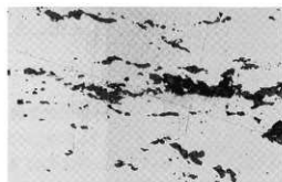
写真9 資料No. 4 鉄釘 無腐食(×100) 延びた黒色物は介在物
