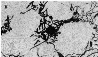
Photo.11 鉄塊系遺物の顕微鏡組織
