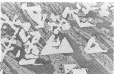
写真7 資料No.2 鉄滓 ( $\times 100$ ) 白色の角形結晶はウルボスピネル
