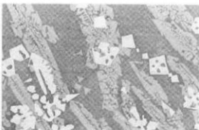
写真6 資料No.1 鉄滓 ( $\times 100$ ) 白色の角形結晶はウルボスピネル
