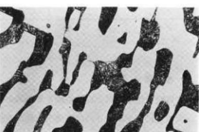
写真9 資料No.5 鋼鉄片 ( $\times 100$ ) 5%ナイタール腐食 基地はパーライト組織
