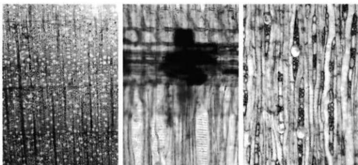
横断面 ————— :0.5mm 放射断面 ————— :0.1mm 接線断面 ————— :0.2mm
