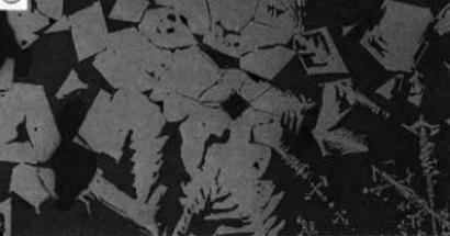
Photo.5 流出滓の顕微鏡組織
