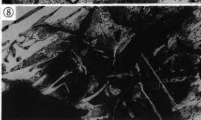
Photo.10 鉄塊系遺物の顯微鏡組織
