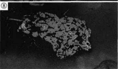
Photo.1 炉壁の顯微鏡組織
