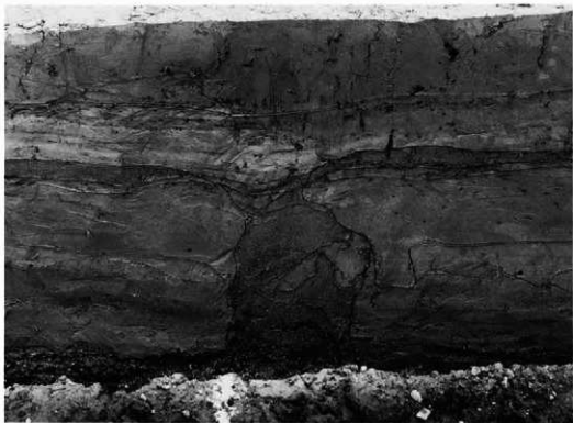
地震痕 (噴砂断面)
