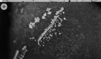
Photo.1 溶解炉炉壁・ガラス質津の顕微鏡組織
