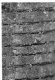
写真3b 漆膜内面に残る糸 (約16倍)
