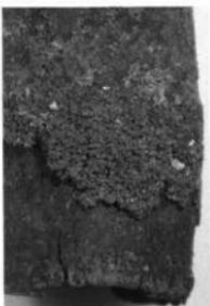
写真1a 漆膜表面に付着した砂鉄
