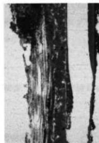
写真4a 糸の縦断面が見える漆膜断面
