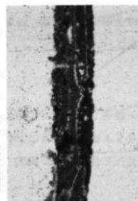
写真4b 糸の歪い部分の漆膜断面
