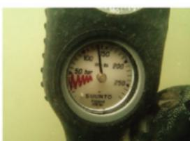
H25-13 ゲージでポンベ空気残圧を確認
