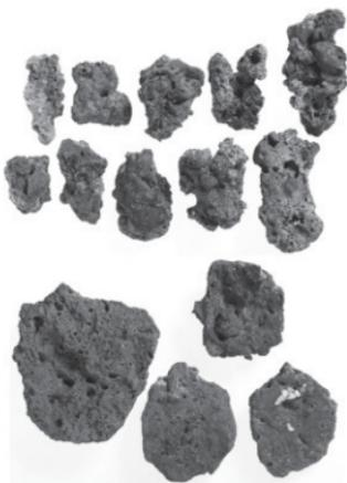
図5 豊原遺跡SQ20出土鉄滓 ( $S=1/3$ )と二酸化チタンの関係図により、鉄滓の性格を判断しているが、ここでは二酸化チタンの値のみで考えねばならない。始発原料を砂鉄とする場合の二酸化チタンの含有量は、製錬滓は1~40%の範囲にあり、精錬滓で0.5~15%、鍛錬鍛冶滓で15%以下とまとめられている(天辰2005)。山海窯跡出土鉄滓の二酸化チタンの値は、0.95~0.97であり、豊原遺跡のものは、0.24と0.42と記されている。さらに豊原遺跡の鉱物組織には、鉄の酸化成分であるヴァスタイトが晶出されており、これは精錬滓や鍛錬鍛冶滓に多く含まれるものである。これらの結果から、豊原遺跡・山海窯跡出土の鉄滓を製錬滓に位置づけることは、できないものと考える。
