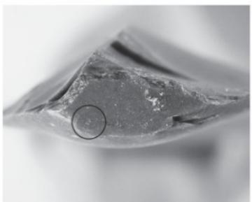
写真 24 打面の剥離開始部上に残る爪状クラック (S=4/1)
